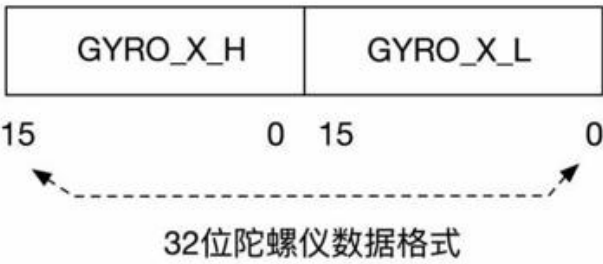
图 14 SPI32 位数据还原示意图
